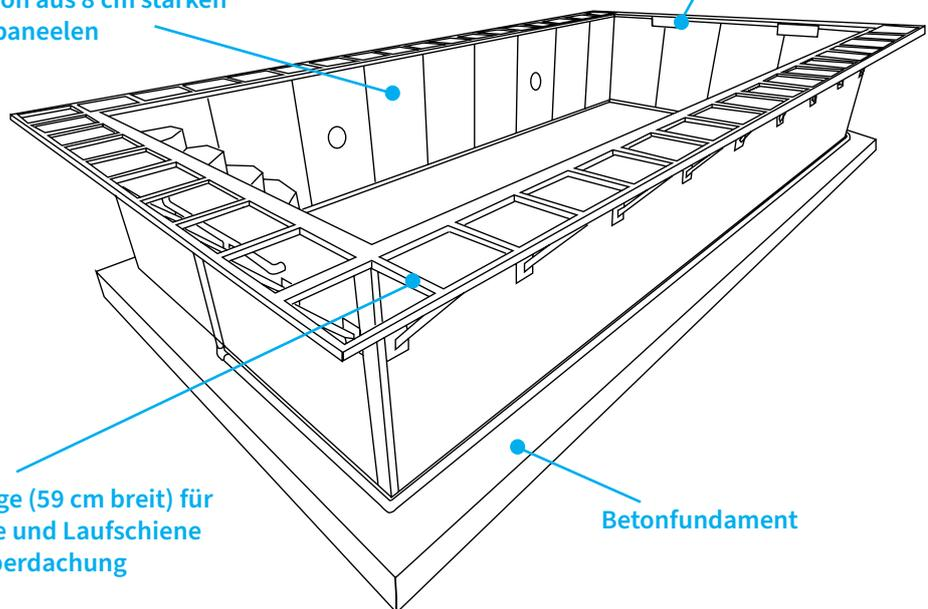
Randauflage (59 cm breit) für Randsteine und Laufschiene der Poolüberdachung
